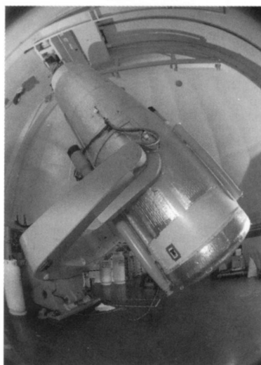
图 6 帕洛马山天文台的施密特望远镜, 主镜口径 1.86m 改正透镜口径 1.22m
