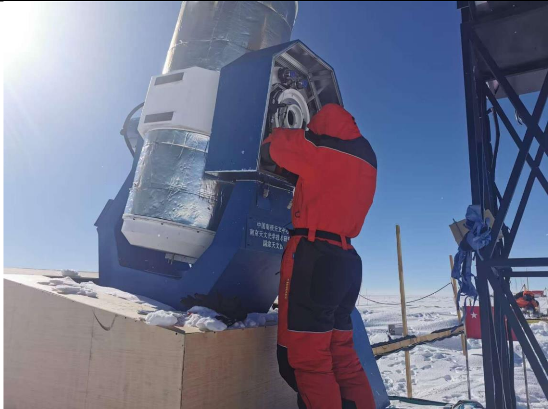
陈超正在维护南极巡天望远镜（AST3-2）赤纬轴
