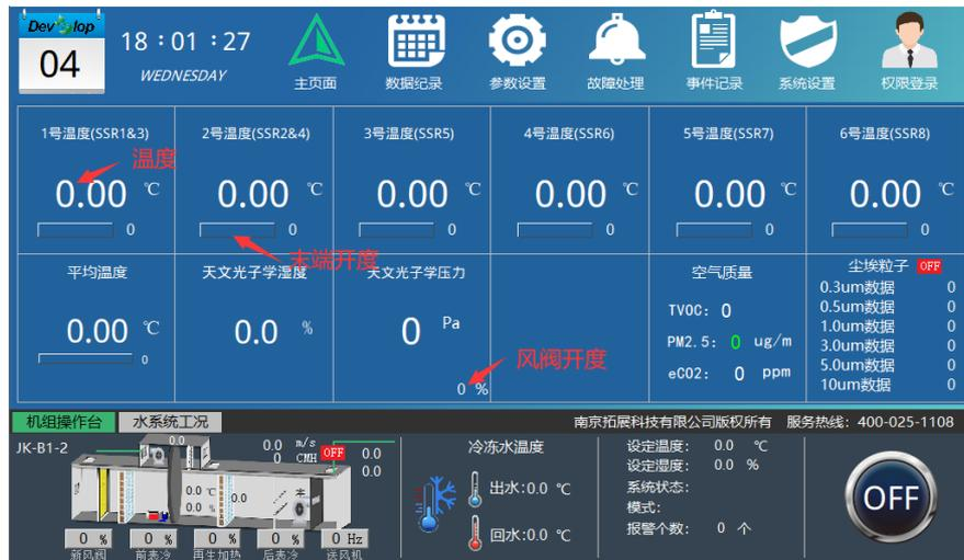
主页面分为4个区域，最上层为画面导航、时间及用户登录；往下为房间状态数据监测区域，集中显示房间温湿度、压力、阀门开度、末端电加热开度、空气质量及尘埃粒子数；再往下为工程信息显示区，显示当前项目所在位置及机组房间名称；最下层为机组工况数据显示及系统开关机操作。
